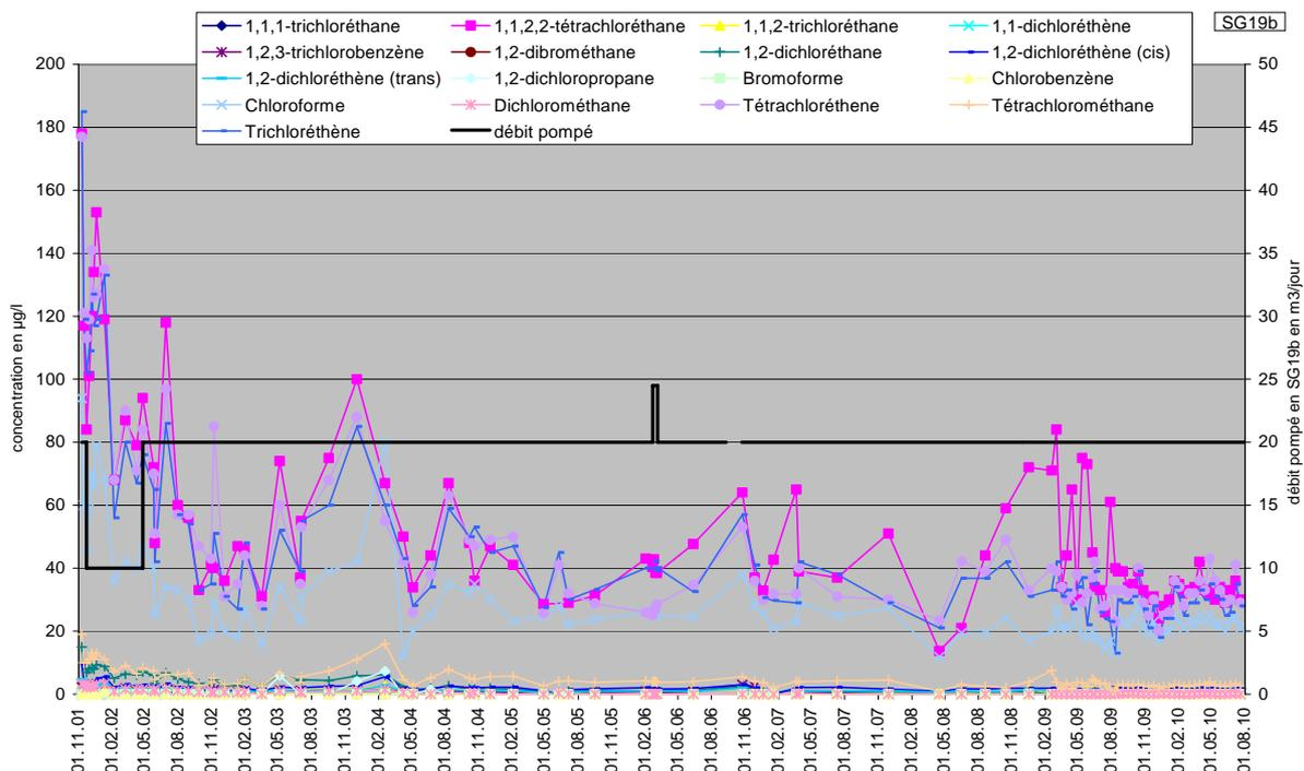
Figure 2 : Suivi du pompage en SG19b, évolution des concentrations dans l'eau pompée
